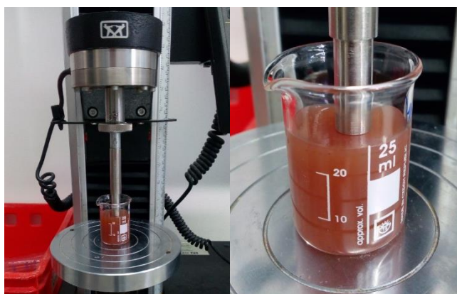
Obr. 1 Měření tuhosti gelu (jahodové pomazánky)
