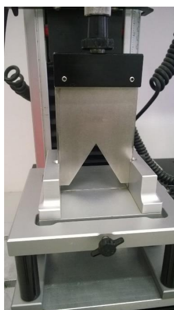
Obr. 3: Nástavec Warner-Bratzler pro měření síly ve stříhu
