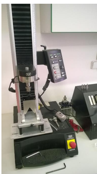
Obr. 2: Instron Model 5544- zařízení pro měření textury
