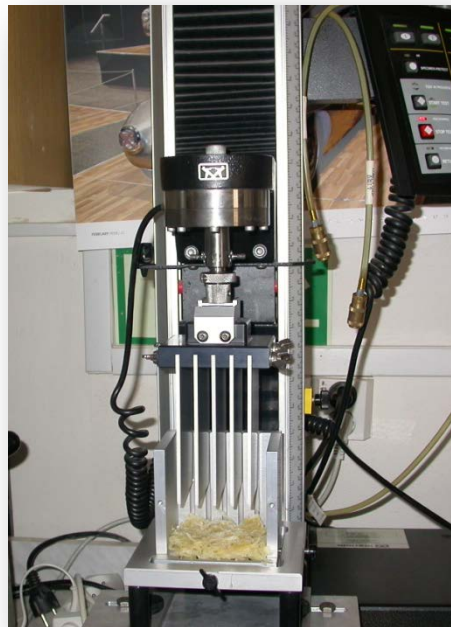
Přístroj Instron s nástavcem Kramerovou celou s pěti noži
