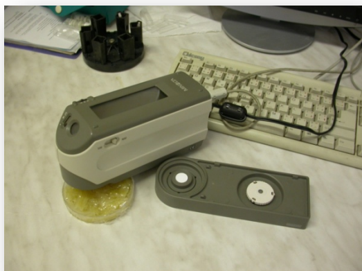
Spektrofotometr CM-2600d (MINOLTA) – měření barvy
